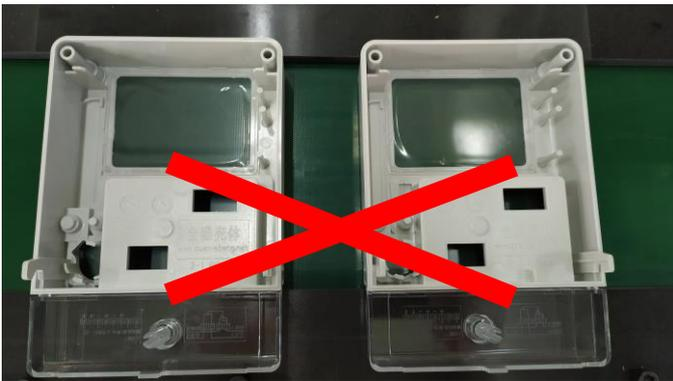
如上图，禁止将表壳分开放，避免气缸压住表壳边缘
